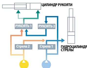
Контур стрелы, рукояти и ковша улучшены для обеспечения плавного и надежного управления в сочетании операций.
