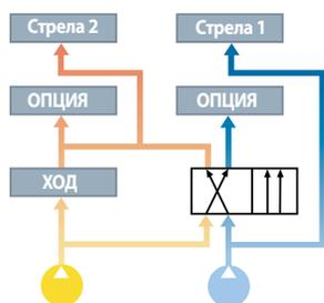
Усовершенствованный гидравлический контур отделяет поток масла для передвижения и работы стрелы, чтобы обеспечить точность и безопасность операций при работе с грузами в движении.
