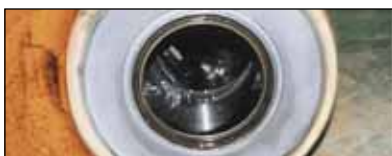
Термическое напыление WC карбида вольфрама
